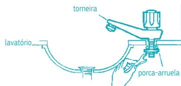
A torneira deverá ser conectada ao ponto de saída de água através de uma ligação flexível, preferencialmente DECA, que contém em sua embalagem as informações necessárias para sua instalação.
